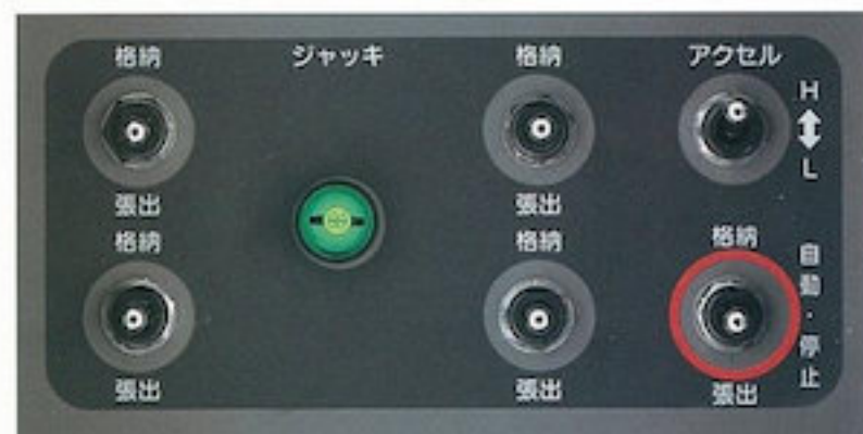
車両後端操作部
