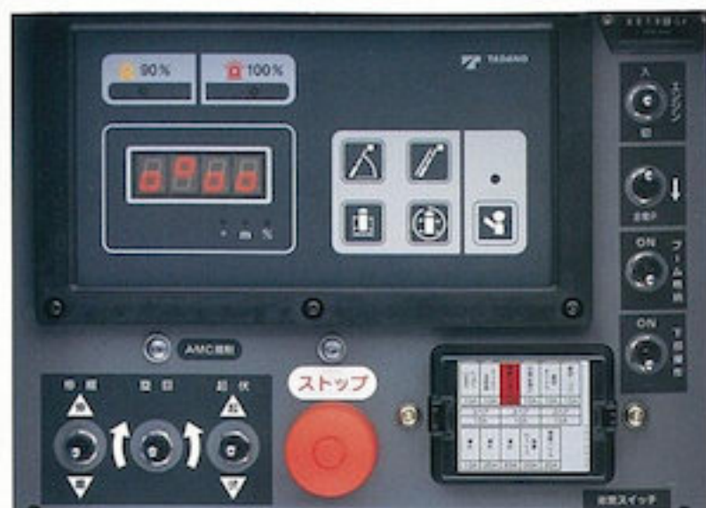
下部左側面操作部
